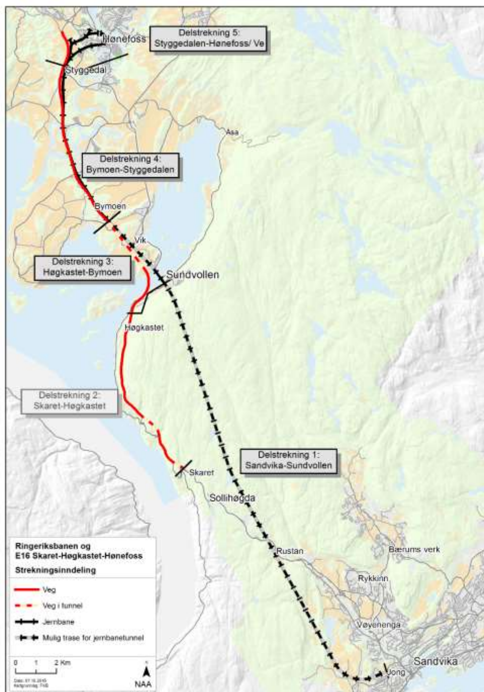
Figur 4-1 Oversiktskart for fellesprosjektet Ringeriksbanen og E16 (delstrekning 2 er separat prosjekt).
